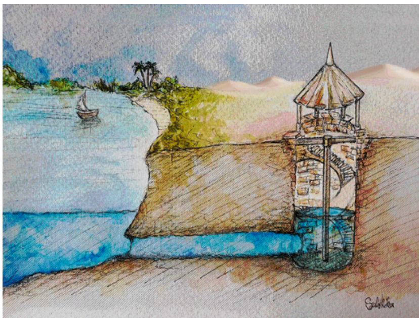
1.1. ábra A nilometer keresztmetszete
