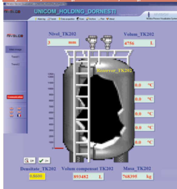
Két gázolajtartály adatainak megjelenítése NIVISION folyamatmegjelenítő szoftverrel
