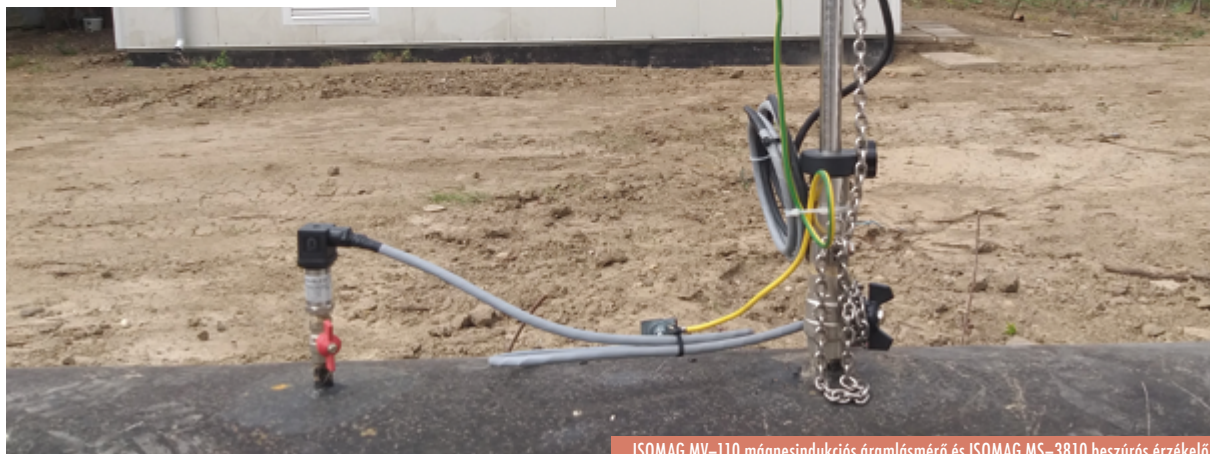
ISOMAG MV-110 mágnesindukciós áramlásmérő és ISOMAG MS-3810 beszűrős érzékelő
