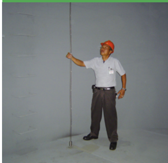
Vegyszertároló tartályok szintjének mérése MicroTREK irányított mikrohullámú szintjeladóval
