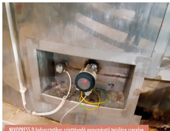
NIVOPRESS D hidrosztatikus szinttávadó nagyméretű tejsilóra szerelve
