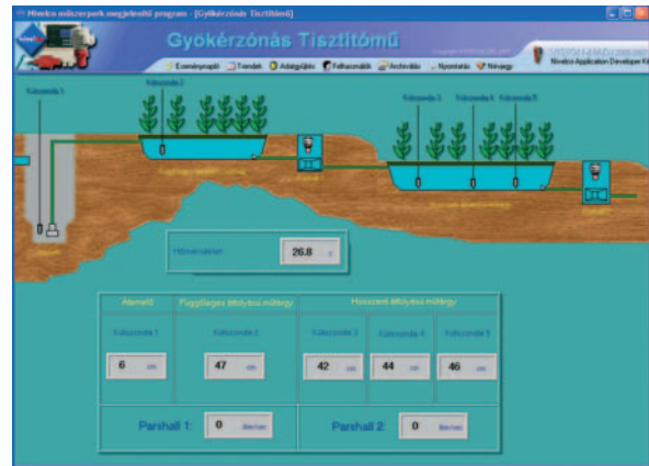
Stație de epurare: Măsurare nivel în bazin cu traductor hidrostatic NIVOPRESS , măsurare debit cu traductor EchoTREK și canal calibrat PARSHALL .
